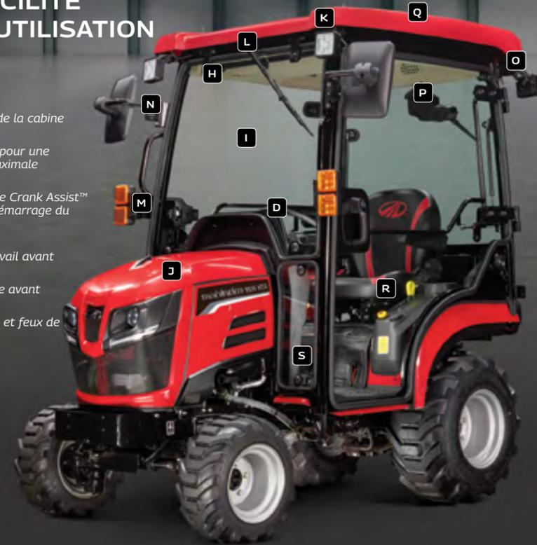
La cabine ROPS (structure de protection contre le renversement) de la série 1100 de Mahindra est conçue, fabriquée et montée dans notre usine d'assemblage. Elle peut être chauffée rapidement et efficacement pour fournir de la chaleur les jours de grand froid. En outre, la cabine vitrée offre une vue à 360 degrés et comprend des feux de travail, des rétroviseurs et des essuie-glaces pour offrir une expérience exceptionnelle, établissant une nouvelle norme dans la catégorie.
